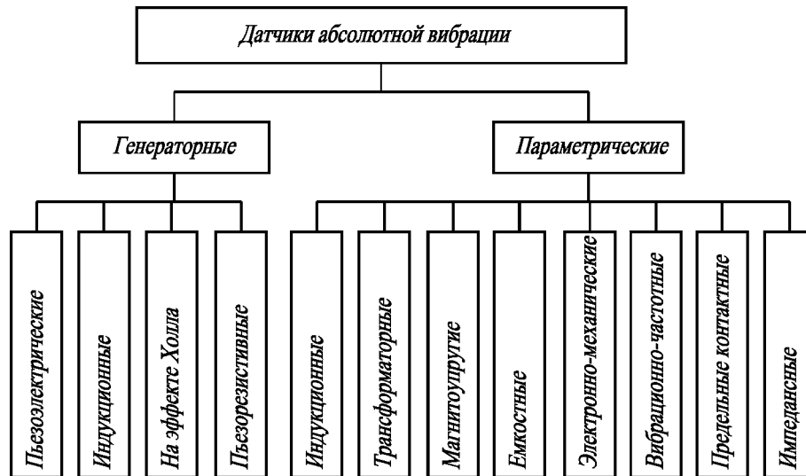
Рис. 1.4. Классификация датчиков абсолютной вибрации по используемым для преобразования физическим принципам
